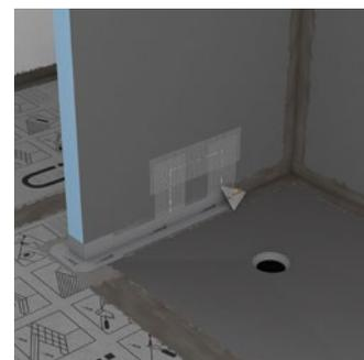
Étanchéifier les raccords avec la bande et les angles d'étanchéité wedi Tools, et le Système d'Étanchéité Liquide (SEL) wedi 520.
