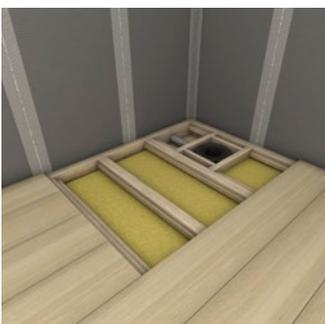
L'écoulement en un point wedi Fundo s'adapte précisément dans le plancher bois sur lambourdes ou solivage.
