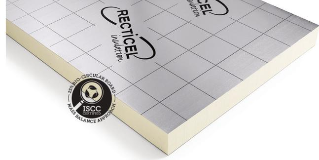
Eurothane Silver Impact est un panneau d'isolation thermique. Son noyau est constitué de mousse rigide de polyisocyanurate PIR. Le panneau est revêtu d'un film multicouche étanche à la diffusion de gaz avec un motif de grille sur les deux faces. Le produit est lié à 25 % de matériaux bio-circulaires (bilan de masse).
